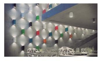
Inverto también cuenta con un controlador intercambiable con configuraciones de 350mA ó 450mA (no aplicable para el modelo directo / indirecto), que proporcionan 16W (60 lm/W, en alta eficiencia) o 21W (54 lm/W en alto rendimiento). La gama Inverto de Lumiance estará pronto disponible en dos temperaturas de color, blanco cálido (3000K) y blanco neutro (4000k).
