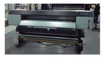
Mimaki JV5 160S, imprime sobre soportes flexibles y en rollo con ancho de 1600 mm. ALTA CALIDAD DE IMPRESIÓN Y VELOCIDAD. Resolución de 540 x 720 dpi e impresión en cuatricomía.
